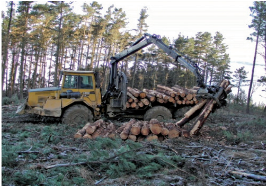
Dumper de obra modificado a autocargador en pino insignne (Vizcaya/Bizkaia)
