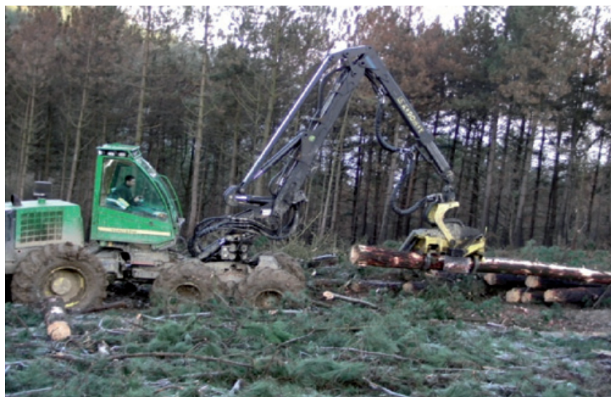
Procesadora de ruedas de origen escandinavo con pino insigne (Vizcaya/Bizkaia)
