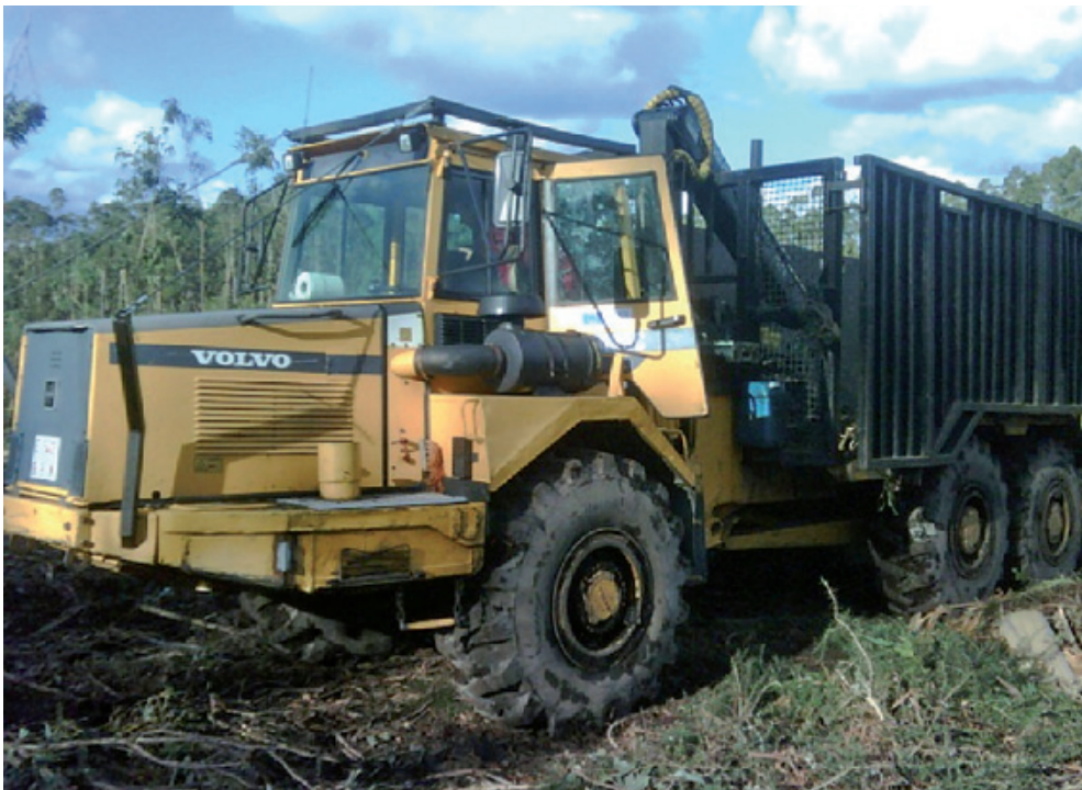
Dúmpster de obra modificado a autocargador de eucalipto (Vizcaya/Bizkaia)
