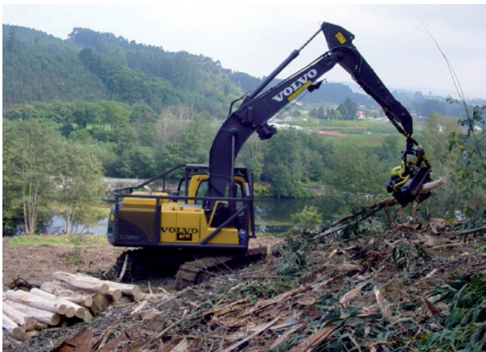
Excavadora adaptada a procesadora de eucalipto
