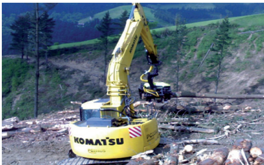
Excavadora de obras públicas con cabezal de pino trabajando con pino insignia (Guipúzcoa/Gipuzkoa)
