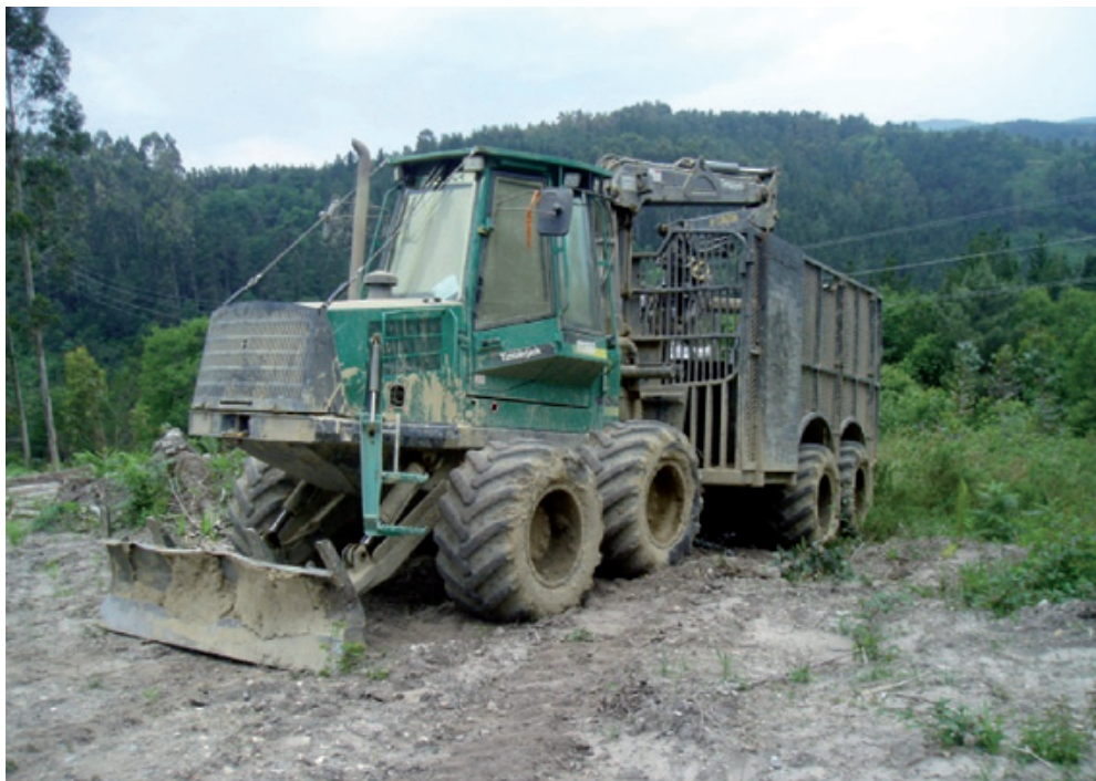
Autocargador de eucalipto de origen escandinavo (Vizcaya/Bizkaia)
