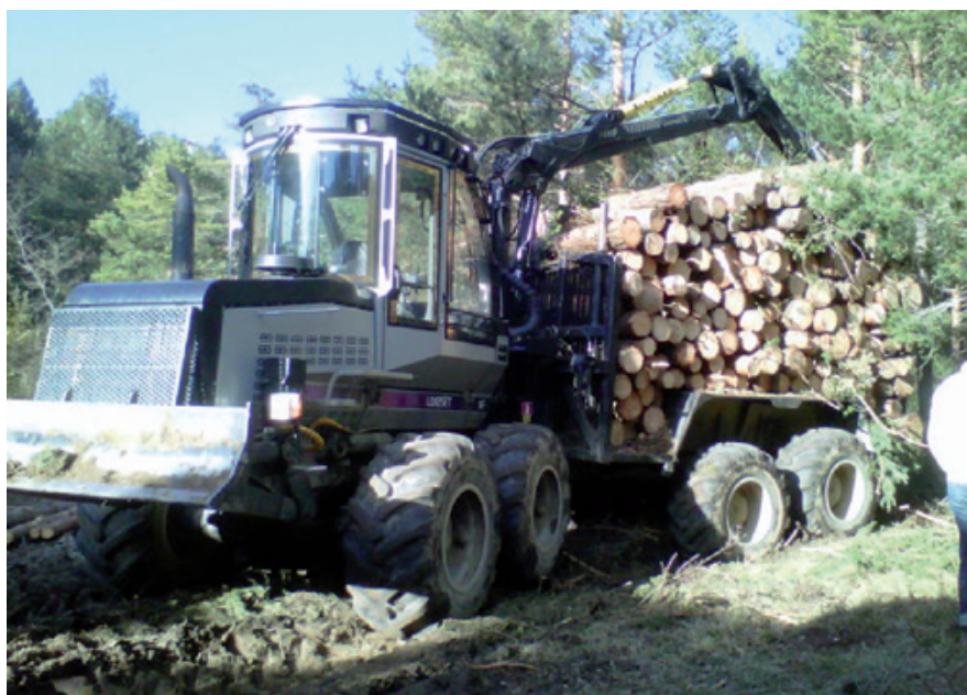
Autocargador de origen escandinavo cargando Pinus sylvestris (Álava/Araba)
