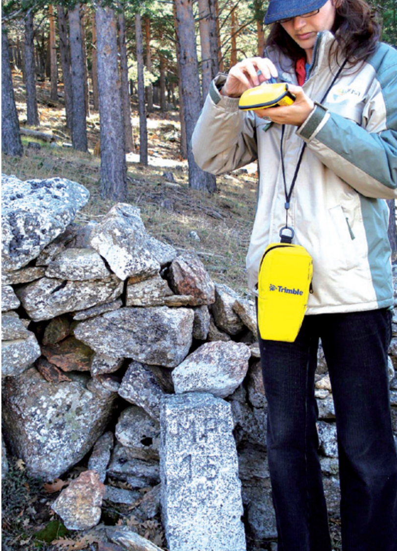
Toma de coordenadas de un majano con GPS centimétrico de doble frecuencia, durante el estaquillado previo al acto de apeo, en el monte "Perímetro de Casasola", n.º 159 del CUP de Madrid, en Robledillo de la Jara
