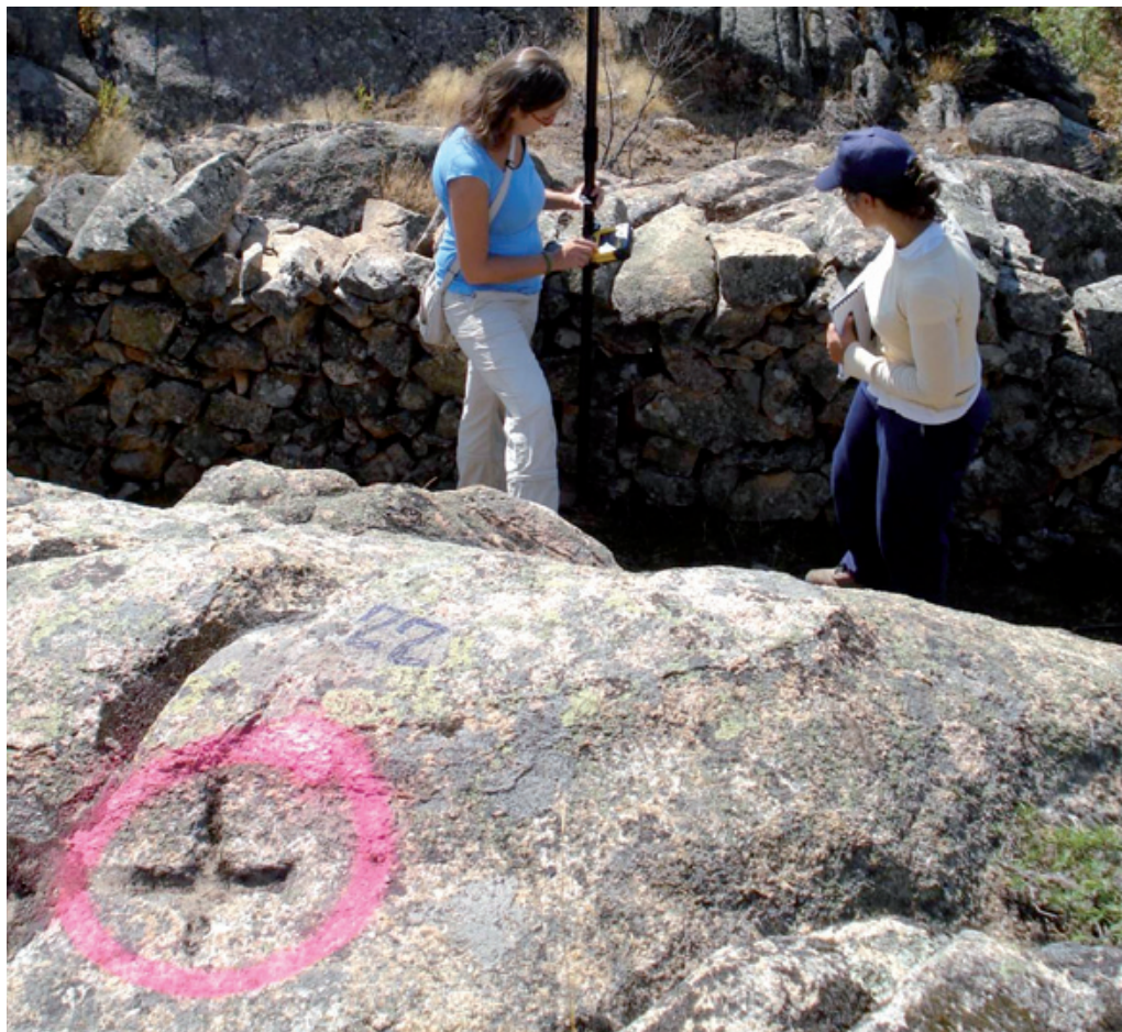
Toma de coordenadas con GPS centimétrico de doble frecuencia durante el estaquillado previo al acto de apeo, en este caso con marca de pintura biodegradable, en el monte “La Camorza”, n.º 163 del CUP de Madrid, en Manzanares El Real
