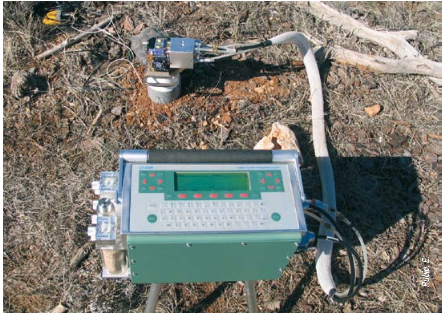
Figura 5: Medición de la respiración del suelo con el analizador de gases Li-6400 y la cámara de suelos modelo Li-6400-09
